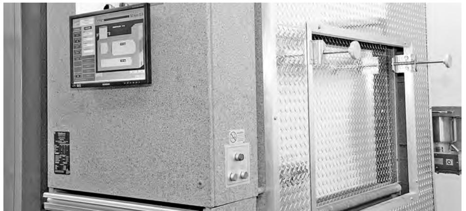
Su sistema de inyección y extracción de aire limpio el ambiente de forma constante y purifica los olores. Así, el oxígeno que se respira es nuevo y no se contamina.
