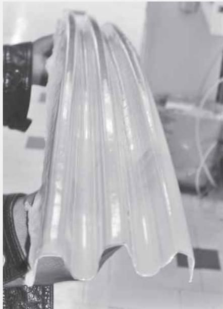
Laminados de PET reciclado nanocompuesto.
