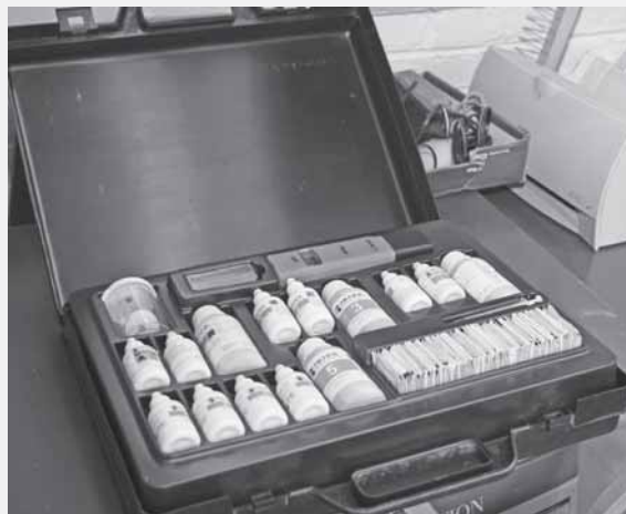
Laboratorio portátil para hacer lecturas de los suelos.
